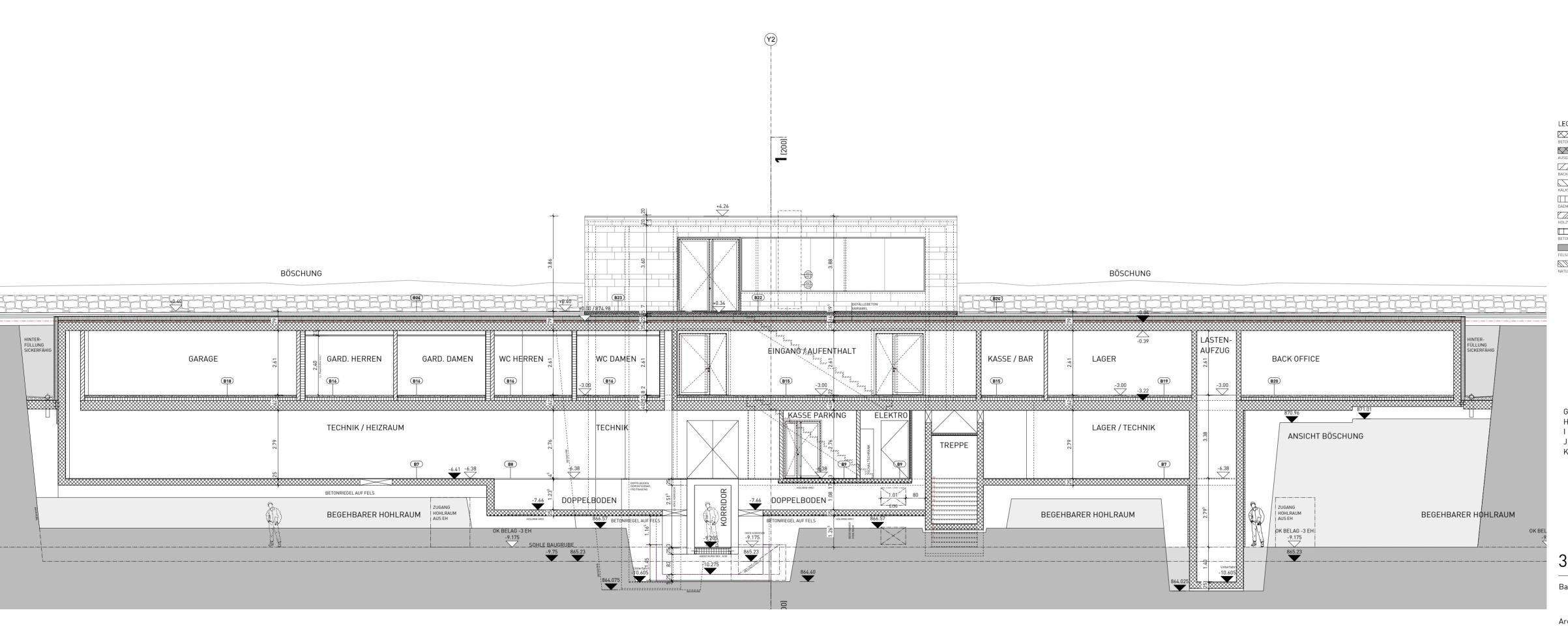
LEGENDE Sämtliche Masse sind Rohmasse ! Mauerqualitäten und Tragwände siehe Bauingeneurpläne. BETON Aussen- und Innenwände (tragend und nicht tragend) Wandlager vorsehen! IL = Im Licht
