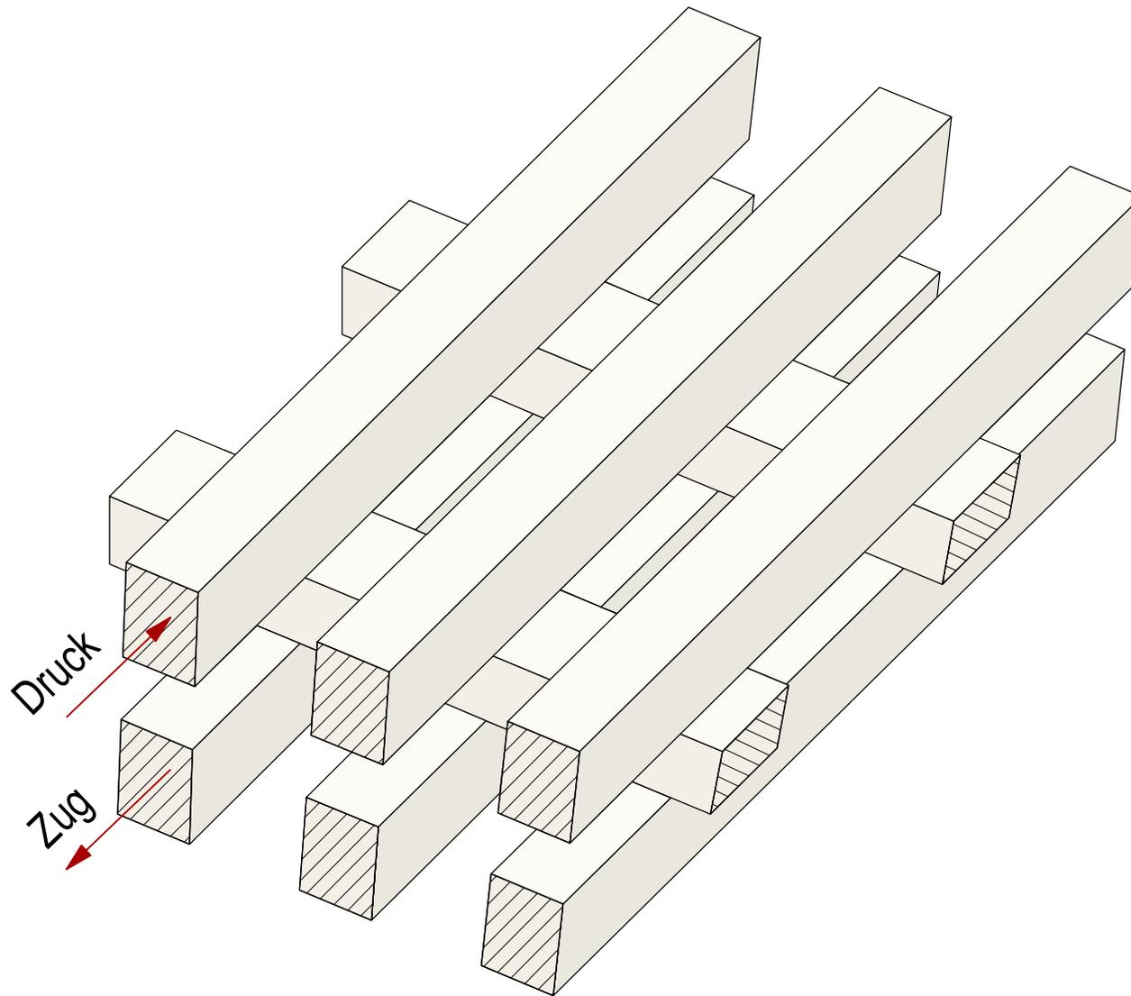
Das Zusammenfügen des Trägers aus Schnittholz entspricht einem Vierendeel-Tragsystem mit dem Ziel "Materialeinsparung".
